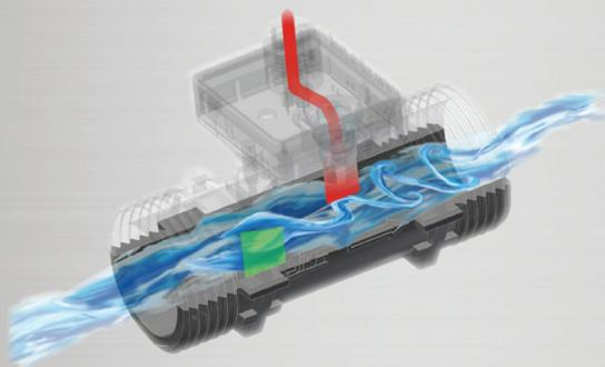
Toutes les chaudières de la série Torus incluent un capteur de débit à vortex Sika configuré en dérivation et indiquant le débit en (gpm). Le capteur de débit à vortex Sika utilise la technologie de vortex et envoie un signal électrique à la plateforme de contrôle de chaudière HeatNet afin d'afficher le débit en temps réel. Le capteur est ajustable selon la plage opérationnelle du modèle.
