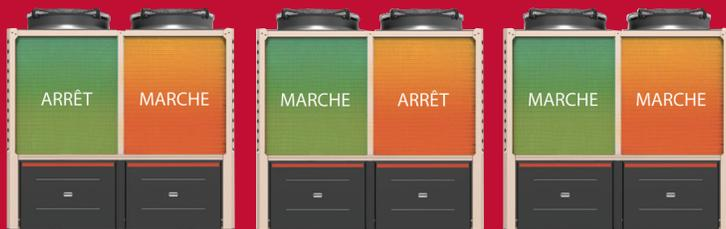
Les thermopompes à inverseur de RBI avec EVI utilisent des systèmes à double compresseur indépendant permettant un fonctionnement individuel adapté à la demande du système. Nos systèmes individuels fonctionnent également en redondance. Si un module a besoin d'entretien, l'autre module peut fonctionner à sa pleine capacité.
